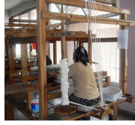
Fotoğraf: 21 Tezgaha çözgü yerleştirme
