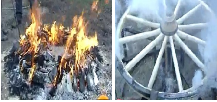
Fotoğraf: 87 Ateşin yakılması Fotoğraf:88 Tekerlekteki çemberin ısıtılması
