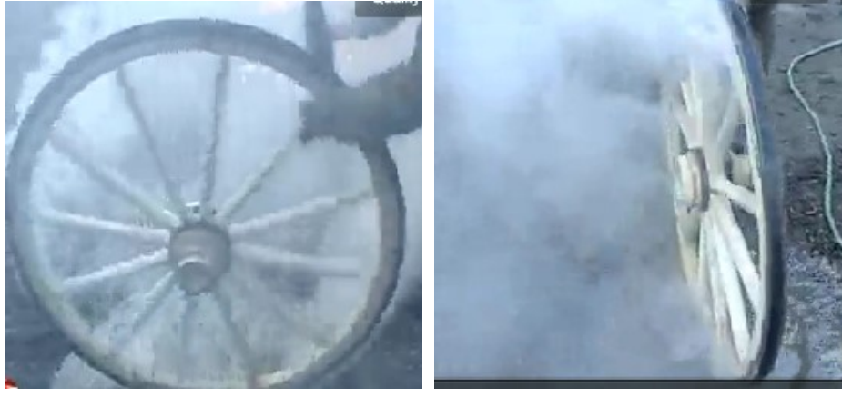
Fotoğraf: 91-92 Soğuyan çemberin tekerleğe tutturulması
