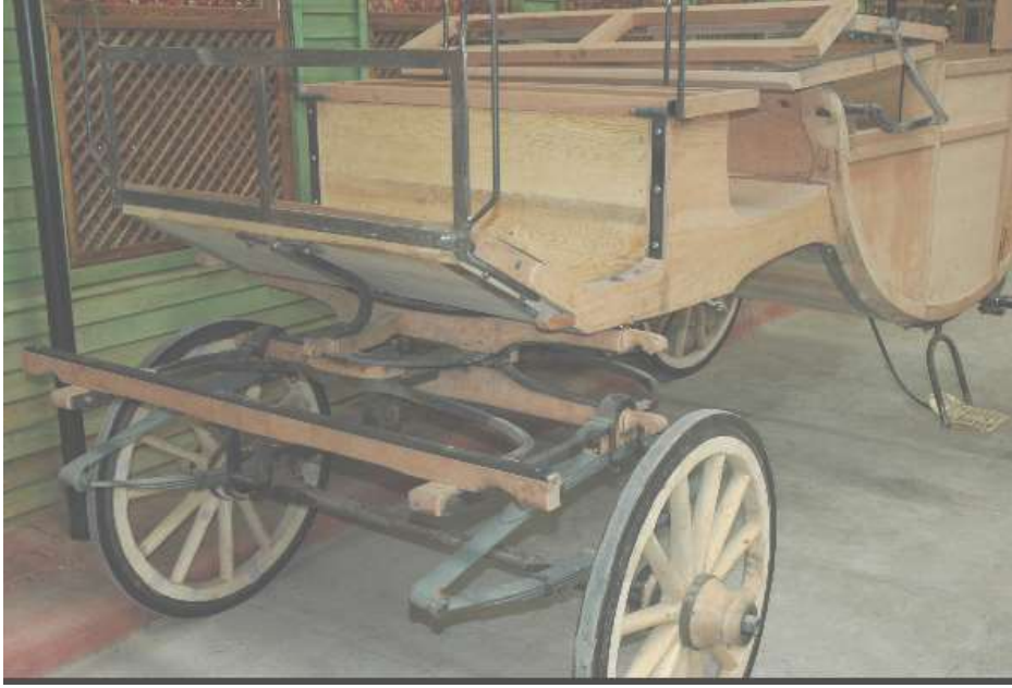
Fotoğraf:97 Faytonun ön takımlarının ve arabacının oturacağı yer. (Güneş fayton)
