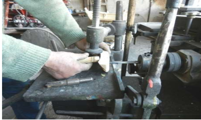
Fotoğraf: 83 İspit makinesinde divanelerin delinmesi
