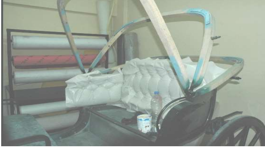
Fotoğraf:99 Faytonun giydirilme aşaması.(Güneş fayton)
